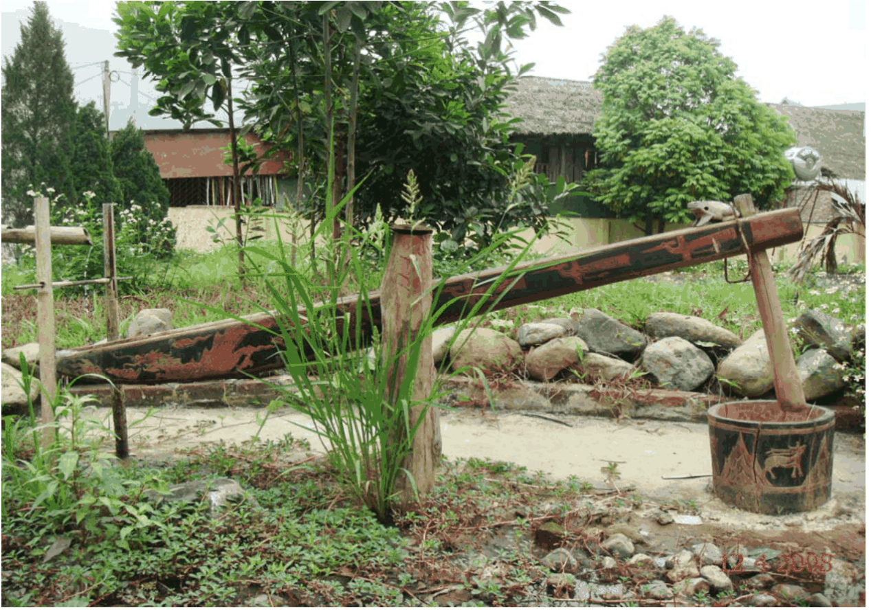
الشكل 1 هاون لبق الأرز يعمل بالطاقة المائية
