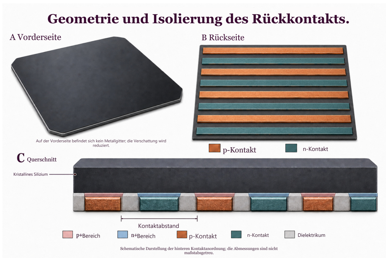
Abbildung 04. Bei der Gestaltung der Rückkontakte haben die Optik der Vorderseite und das Muster der Rückseite unterschiedliche Funktionen. Die beiden Kontaktnetze müssen voneinander isoliert bleiben; Ausrichtung, Abstand und Transportstrecke müssen gemeinsam betrachtet werden. Die Kontaktphysik hängt von der gewählten Architektur ab. [C01] [C02] [D10] Mit einem Bildgenerierungswerkzeug erstellte konzeptionelle Illustration; keine Messaufnahme.
