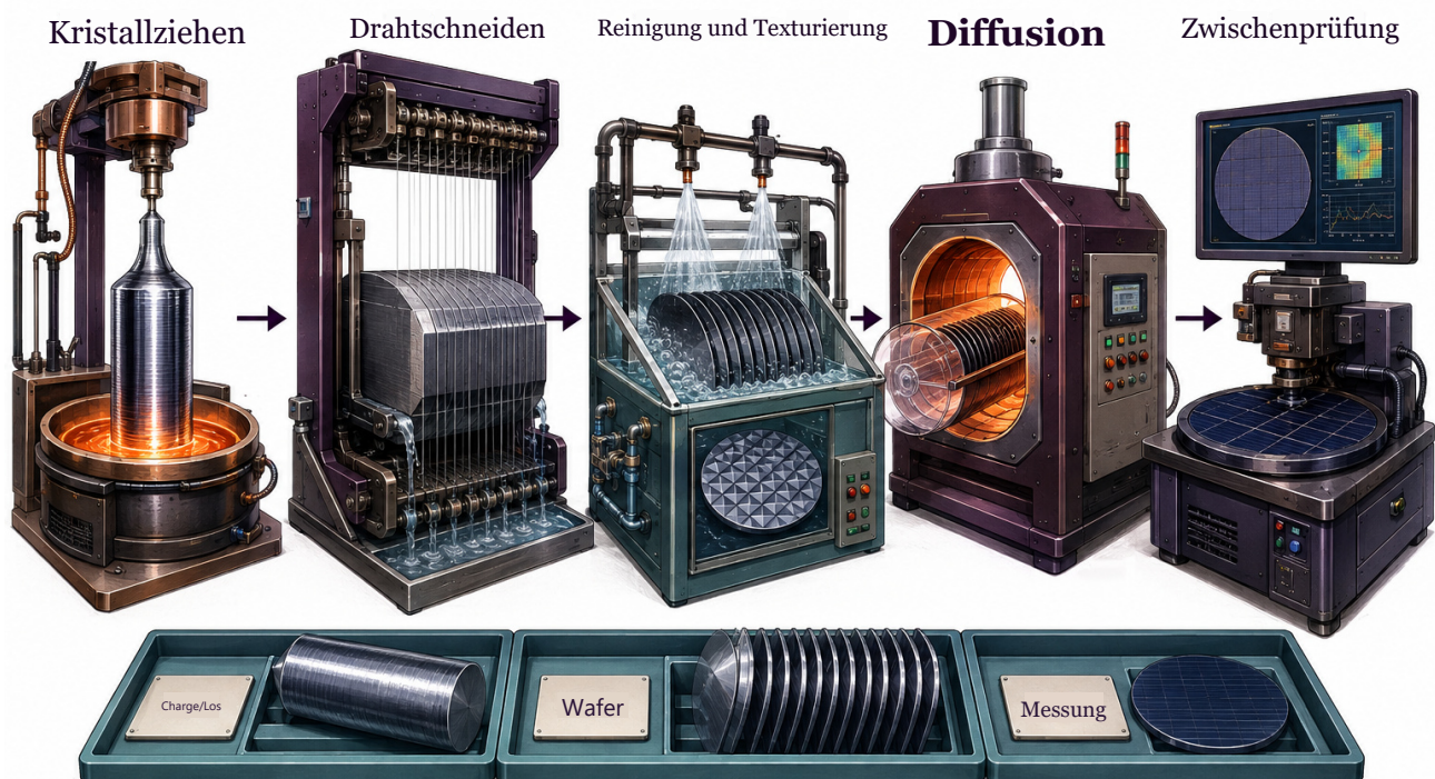
Abbildung 01. Prozesskette vom Kristall zur Zellvorstufe. Drahtschneiden, Oberflächenvorbereitung, Diffusion und Zwischenkontrolle steuern verschiedene Qualitätsvariablen; das Verfahren ist nicht die spezifische Rezeptur einer bestimmten Fabrik. [D01] [D06] [D07] [D08] Mit einem Bildgenerierungswerkzeug erstellte konzeptionelle Illustration; keine Messaufnahme.
