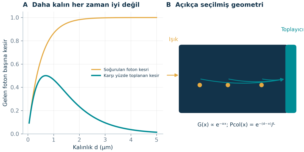
Şekil 37. Kalınlık optimumunun açık geometri örneği. Solda soğurma monoton artarken karşı yüz toplayıcıya ulaşan kesir bir maksimumdan geçer. Sağdaki geometri ve formülde \alpha = 2 \mu\text{m}^{-1} , L = 1 \mu\text{m} kullanılır. Üstel toplama olasılığı öğretim modelidir; gerçek bir heteroyapının Poisson-taşıma çözümünün yerine geçmez.
