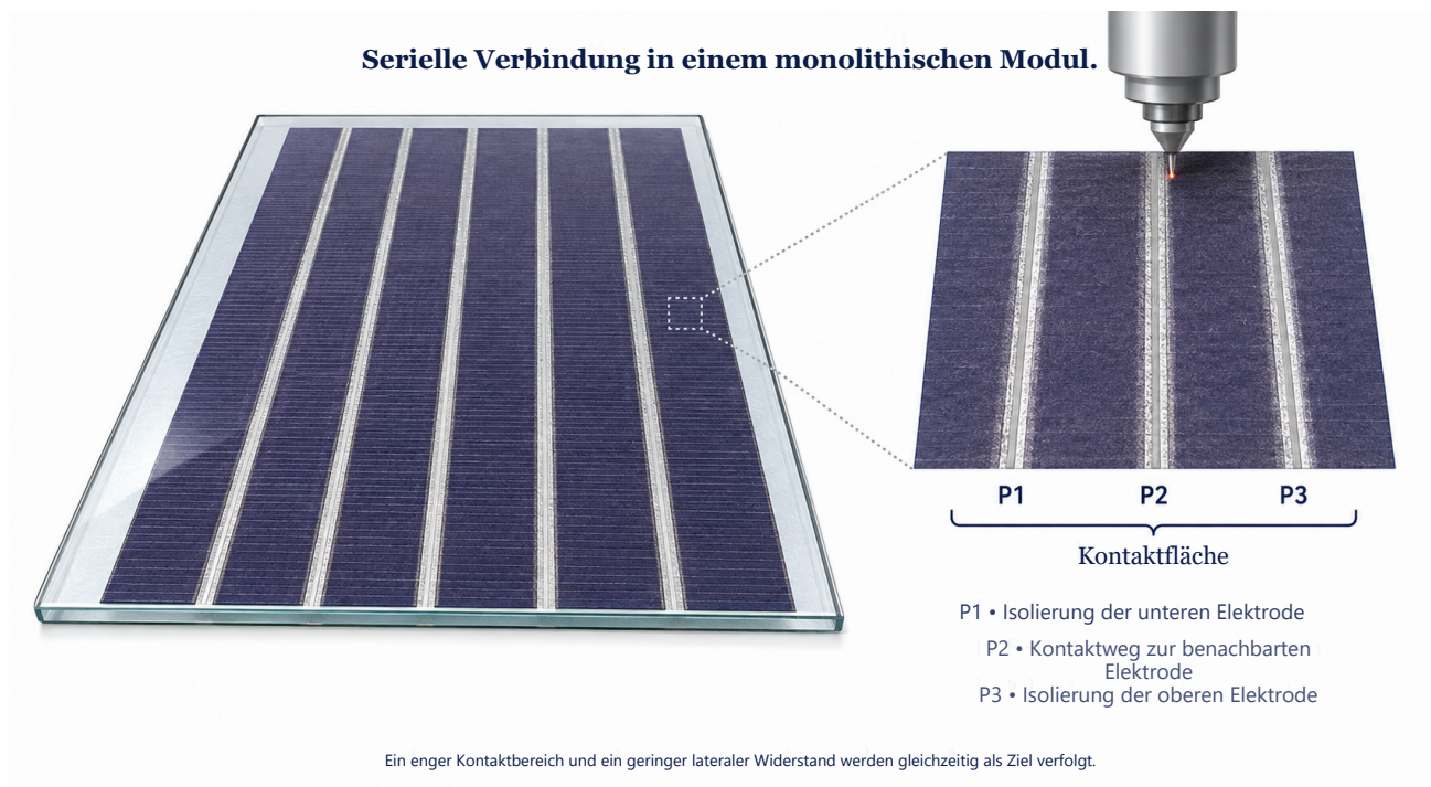
Abbildung 29. Zellstreifen und Verbindungslinien in einem monolithischen Dünnschichtmodul. Die Draufsicht erinnert an die unterschiedlichen Funktionen der Schritte P1, P2 und P3 sowie an die inaktive Verbindungsfläche; es handelt sich nicht um einen Produktionsquerschnitt, der die Ritzentiefen der Schichten zeigt. Die Linien und Streifenbreiten sind schematisch dargestellt. Im folgenden Panel wird der quantitative Zielkonflikt zwischen geometrischem Füllfaktor und lateralem Widerstand berechnet. [T29] [R34] Mit einem Bildgenerierungswerkzeug erstellte konzeptionelle Illustration; keine Messaufnahme.
